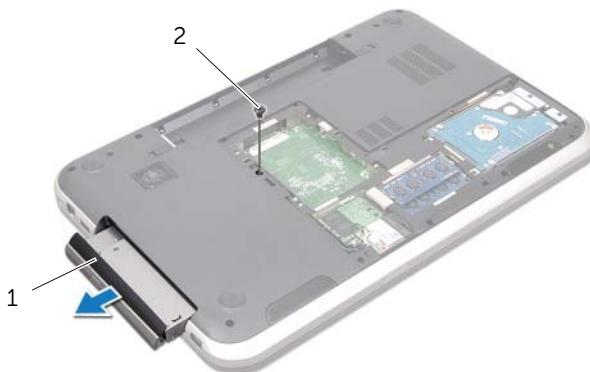
1 sklop optičke disk jedinice 2 zavrtanj
